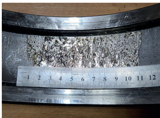
Рис. 2. Дефекты дорожки качения наружного кольца
