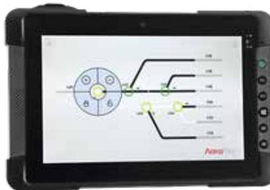
Защищенный планшет для радиоуправления стрелочными приводами
